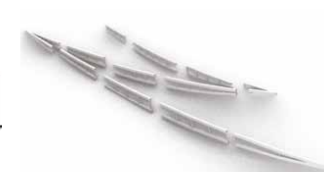
Figur 2-11: Primärbalkarna föreslås tillverkas i delar som monteras ihop på plats.
